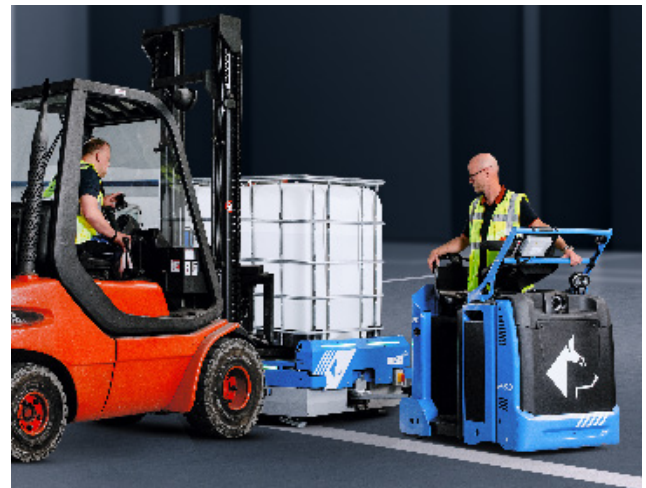
Beladung des Routenzuganhängers auch per Gabelstapler möglich
