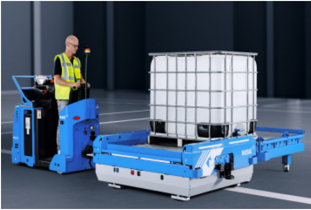
Automatischer Ladungsträgerwechsel für Gewichte bis zu 2 Tonnen
