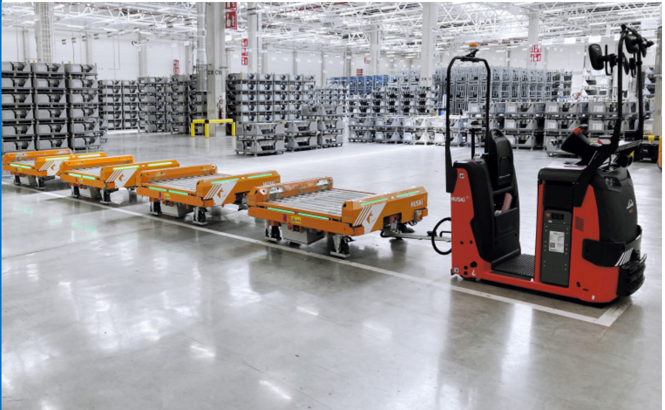
Routenzug zur internen Materiallogistik bei der Mercedes-Benz AG
